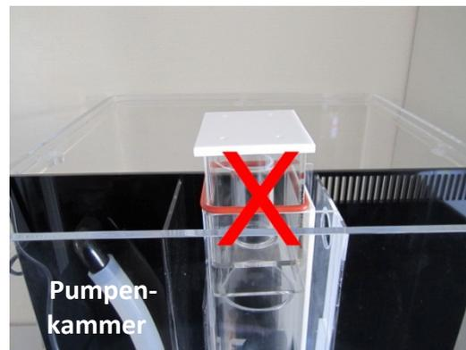
SH1s falsch montiert. Die geschlossene Seite des Eiweißabschäumers zeigt zur Pumpenkammer.
