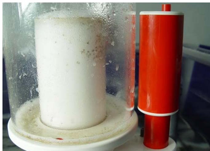
Die ersten Tagen unbedingt mit offenem Auslauf arbeiten. Erst nach dem „Einlaufen“ den Stopfen montieren.
