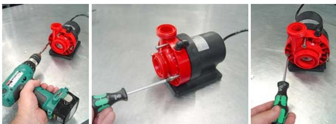
Mit passendem Inbuschlüssel die 4 Gehäuseschrauben ausdrehen.
