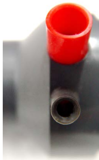
Düsenteil mit Luft- und Ozon-Anschluss
